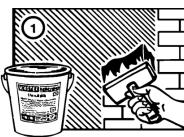
Odmah nakon toga rukom utrijati KÖSTER KD 2 prah u svježi, vlažni sloj premaza sve dok se površina ne osuši.
