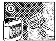
Odmah nakon ugraditi KÖSTER KD 1 te nakon 30 minuta ponovno ugraditi KÖSTER KD 1.
